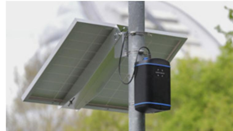
Der Zephyr Luftqualitätssensor von EarthSense kann auf Fahrrädern und entlang von Straßen eingesetzt werden, um hochauflösende Luftqualitätsmessungen in Echtzeit durchzuführen
