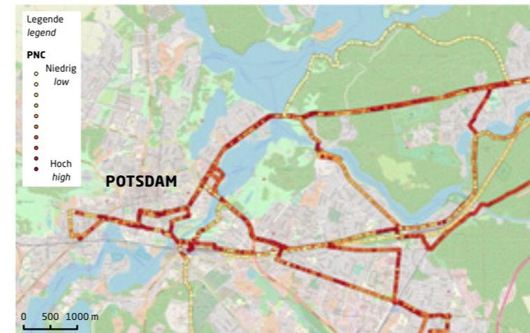
Der Luftverschmutzungsgrad (Partikelanzahlkonzentration [PNC]), gemessen während einer Fahrrad-Messkampagne
