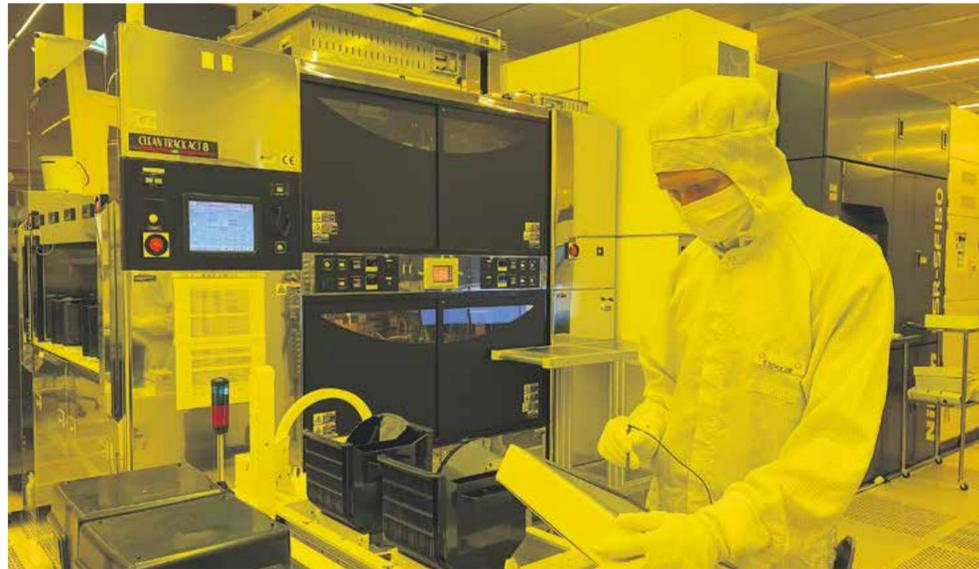
Der Reinraum des IHP ist 1500m² groß. Fotolithografie zur Fertigung von integrierten Schaltungen – unter gelbem Schutz-Licht
