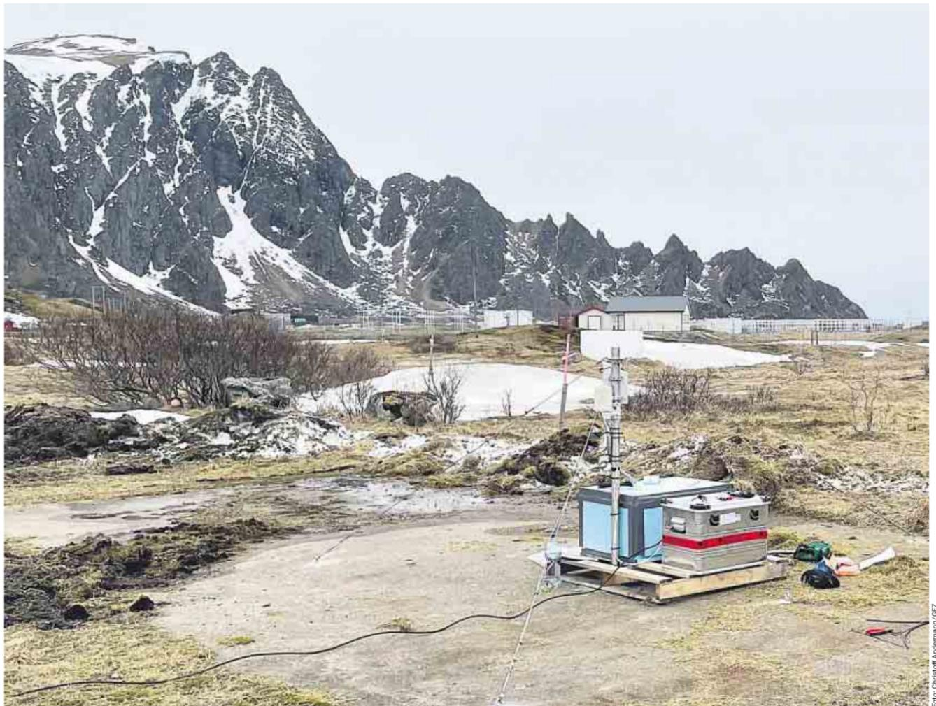
**Raus aus dem Elfenbeinturm.** Das Bild zeigt einen maßgeschneiderten „Autosampler“, der Regenwasser über längere Zeiträume für Isotopenanalysen sammelt. Er wurde von der Werkstatt und den Forschern des GFZ gebaut und ist mittlerweile patentiert.
